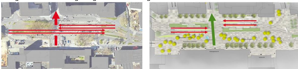
Verkehrssicherheit durch Trennung der Haltepunkte; links heute, rechts nach Neuordnung
